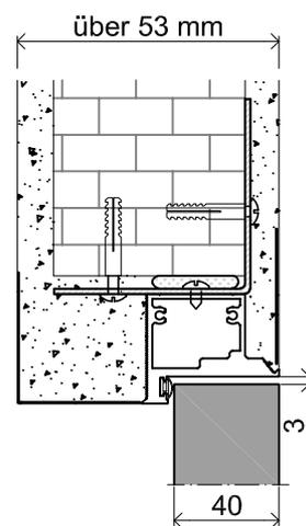
Standardabmessungen für Türen nach außen öffnend
